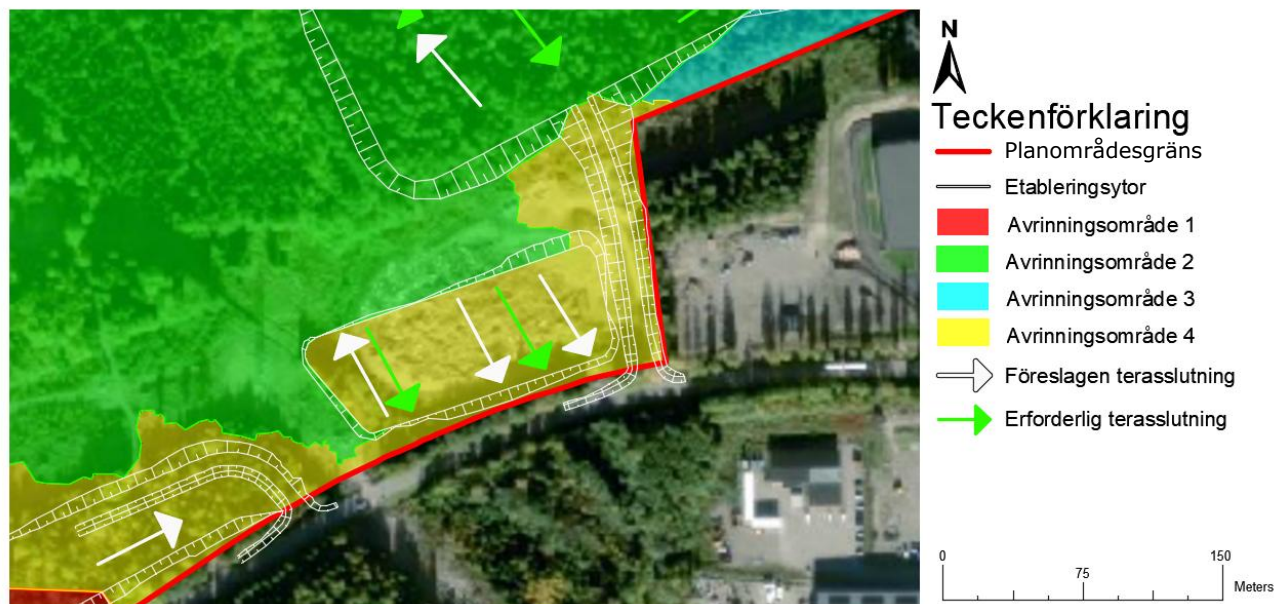
Figur 6.2-6 Etableringsyta C:s föreslagna och erforderliga lutning.
