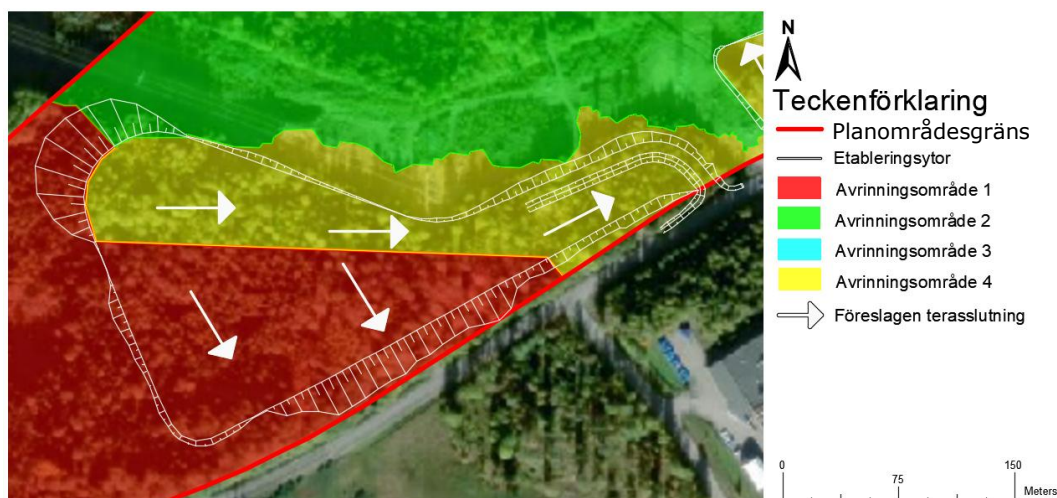
Figur 6.2-4 Etableringsyta A:s föreslagna lutning.
