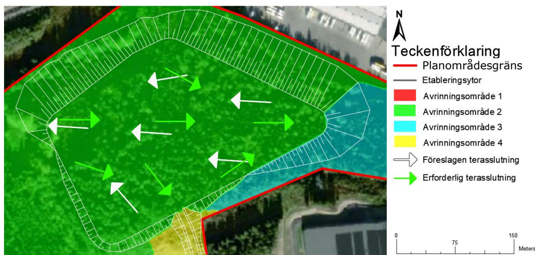
Figur 6.2-5 Etableringsyta B:s föreslagna och erforderliga lutning.
