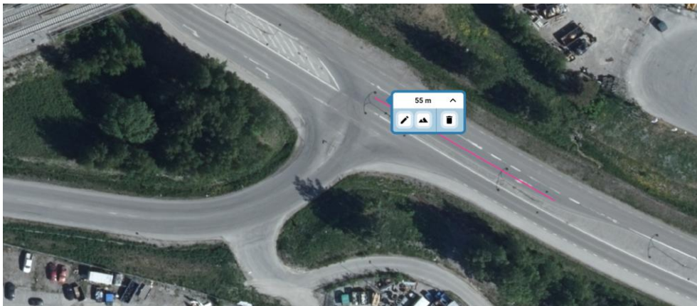
Figur 22. Längd på vänstersvängfält för Timmervägens (väg 622). Bildkälla: Lantmäteriet, hämtad 2024-09-12
