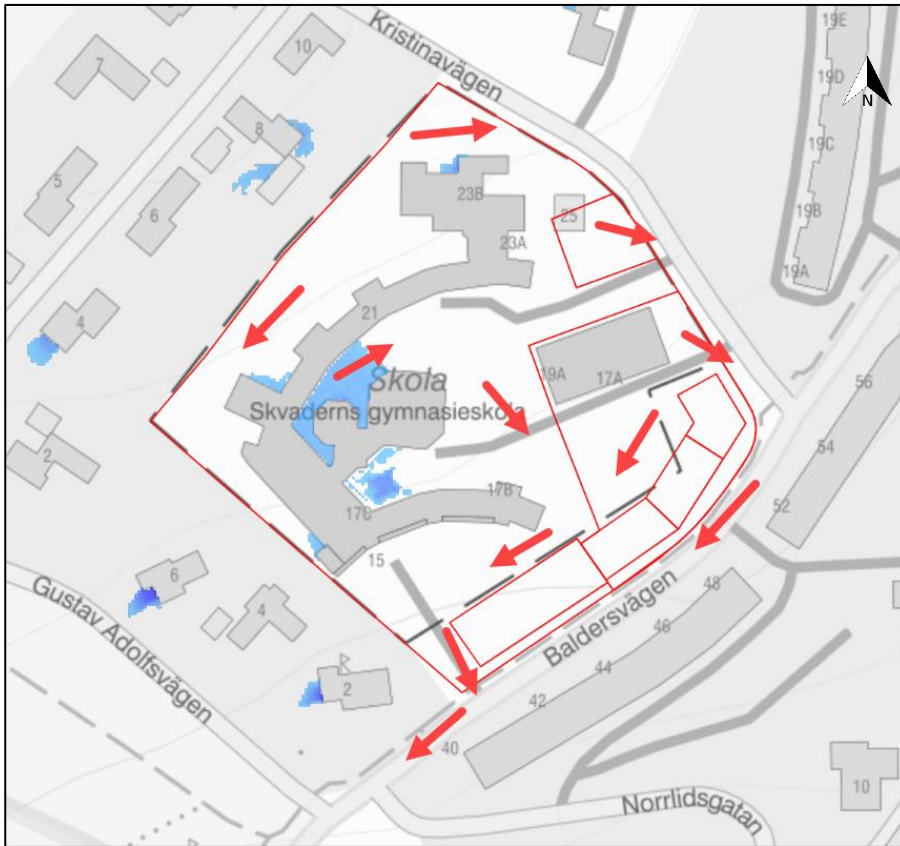
Figur 13 Översvämningsrisk på grund av skyfall. De blåa områdena visar var vatten kan bli stående. Detaljplanen är markerad med röd linje. Förslag på sekundära rinnvägar visas med röda pilar. Data är hämtad från Scalgo Live 2025.
