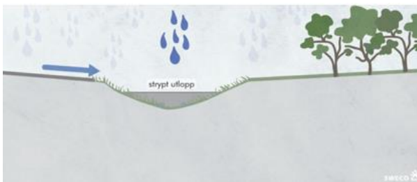
Figur 15. Exempelutformning på ett svackdike.
