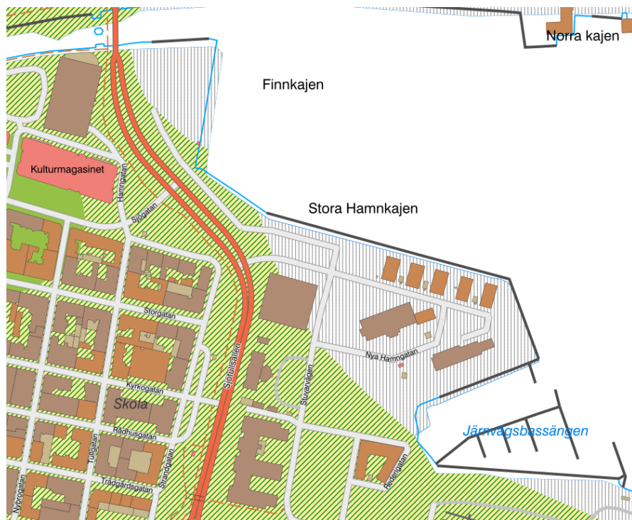
Figur 4. Jordartskarta över område med aktuell fastighet Tullpaviljongen 1:2, ungefärligt läge markerat med röd rektangel. Grå-streckat motsvarar grundlager av fyllning, gult med gröna streck motsvarar grundlager av silt med underliggande lager av isälvssediment. Längst till vänster i bild ses område med grön färg, där grönt motsvarar grundlager med isälvssediment (SGU, 2025).
