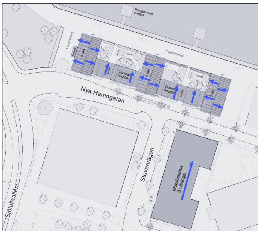
Figur 11 Flödesriktning (blå pilar) visar ett förslag på avvattning från tak. Underlagskarta från tävlingsbidraget i jämförelseförfarandet 2024 (SWECO)
