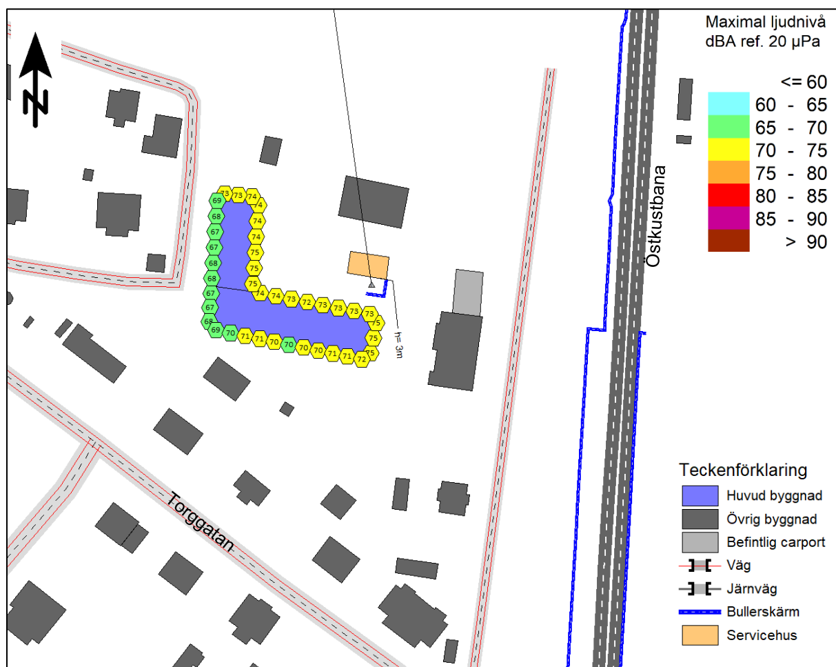
Figur 5. Beräknad maximal ljudnivå vid fasad. Det våningsplan med högst ljudnivå redovisas i figuren
