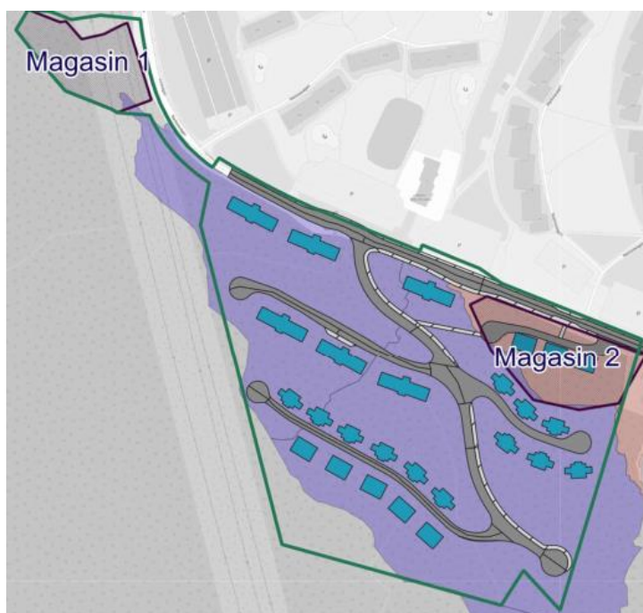
Figur 27. Redovisning av magasin 1 (inom det västra avrinningsområdet) respektive magasin 2 (inom det östra avrinningsområdet). Källa: Sweco
